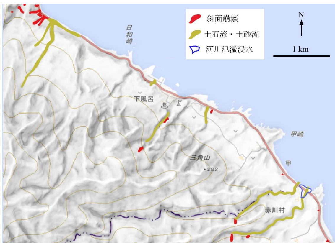
図3 焼山崎～赤川村における斜面崩壊や土石流・土砂流や河川氾濫浸水分布（基図：地理院タイルに加筆）
